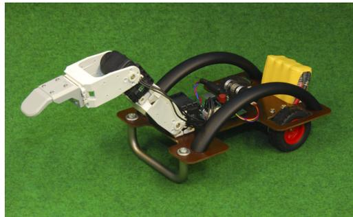
einfacher Roboter mit zwei Freiheitsgraden
